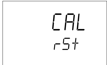
Abbildung 6 - Das Einstellen des Messers nach den Fabrikseinstellungen
